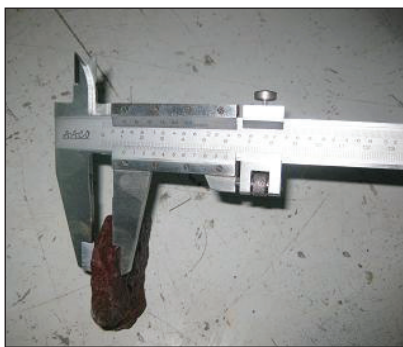
◀ کولیس تعیین اندازه ذرات سنگدانه ها
