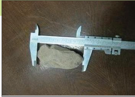
◀ کولیس تعیین ابعاد سنگ دانه‌های طویل
