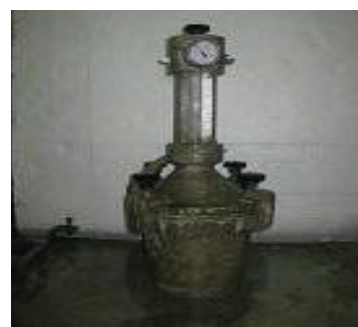
◀ دستگاه تعیین درصد هوای بتن تازه
