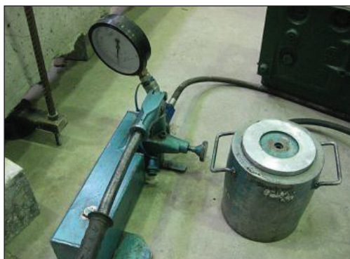
◀ آزمایش بارگذاری صفحه (Plate Loading Test)
