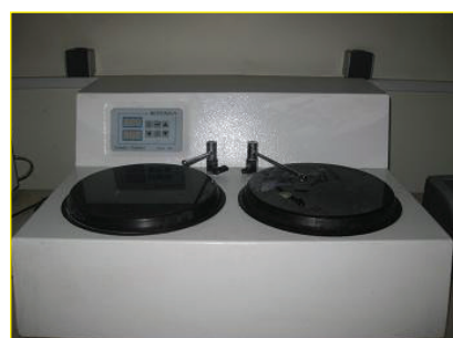
◀ دستگاه پرداخت سطوح (ویبراتور به منظور یکنواخت کردن سطح)
