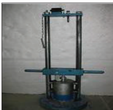
◀ دستگاه آزمایش مقاومت سنگدانه‌ها در برابر جذب
