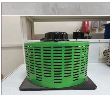
◀ اتوترانسفورمر تک فاز با توان KW 2.5
