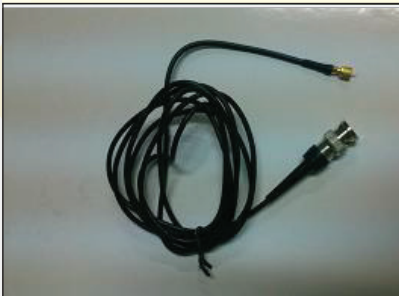
◀ سییم ۲ متری یک سر اتصال به Data Logger و یک سر اتصال به شتاب سنج
