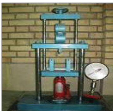
◀ مقاومت خمشی نمونه ۱۶*۴*۴
