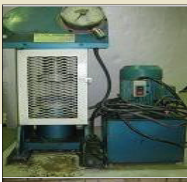
◀ مقاومت فشاری نمونه ۱۶*۴*۴
