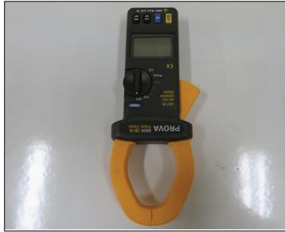
دستگاه اندازه گیری توان بصورت AC-DC clamp تا 2 KW ◀
