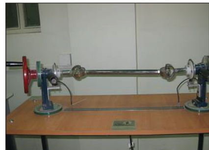
◀ قفل گاردان منفرد و دابل (دینامیک چهارشاخ گاردان)
