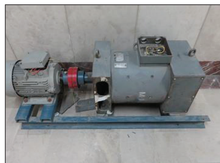
◀ مجموعه ژنراتور (موتور سه فاز آسنکرون + ژنراتور DC)
