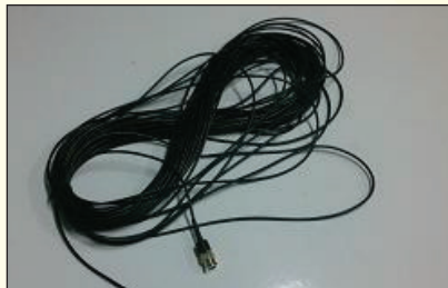
سیم ۱۰ متری یک سر اتصال به Logger و یک سر اتصال به شتاب سنج
