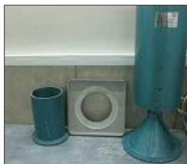
◀ تجهیزات اندازه‌گیری دانسیته در محل بررسی مخروط ماسه
