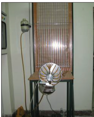
◀ دستگاه اندازه گیری توزیع فشار روغن در یاتاقان ژورنال
