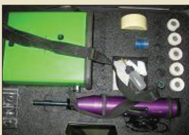
◀ دستگاه چکش اشمیت جهت اندازه گیری مقاومت بتن
