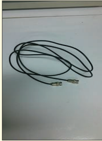
سیم ۲ متری هر دو سر اتصال به Data Logger
