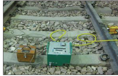
◀ دستگاه اندازه گیری مقاومت (SSCP) جانبی خط
