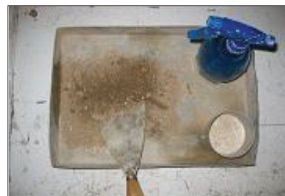
◀ نمونه گیر خاک جهت اندازه‌گیری درصد رطوبت
