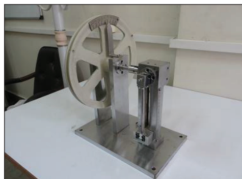
◀ کالیبراتور و پایه تست عملگر الکترومکانیک
