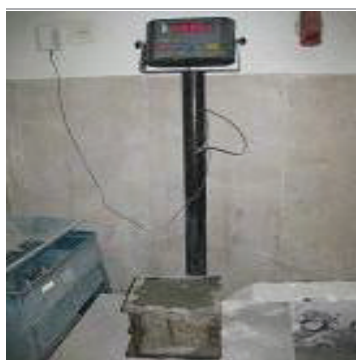
◀ دستگاه اندازه‌گیری وزن مخصوص بتن تازه
