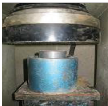
◀ دستگاه آزمایش مقاومت خردشدگی سنگدانه‌ها
