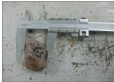
◀ کولیس تعیین ابعاد سنگ دانه های کروی و گردگوشه
