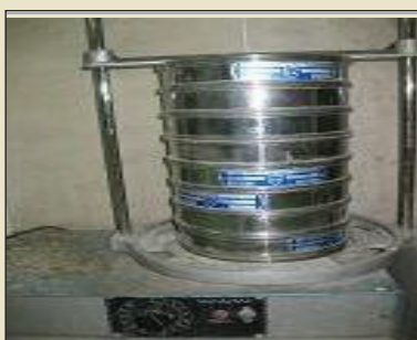
◀ دستگاه دانه‌بندی مکانیکی با استفاده از الک (Shaker)
