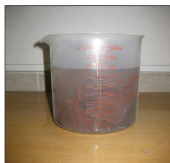
◀ بالن مورد استفاده در تعیین درصد جذب آب مصالح
