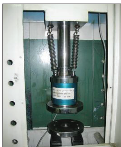
◀ آزمایش فشار و کشش با پمپ دستی
