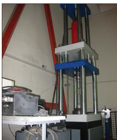
◀ دستگاه کشش ۵ تنی هیدرولیکی
