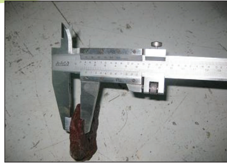
◀ کولیس تعیین اندازه ذرات سنگدانه ها
