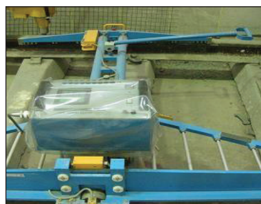
◀ دستگاه اندازه گیر پارامترهای هندسی خط
