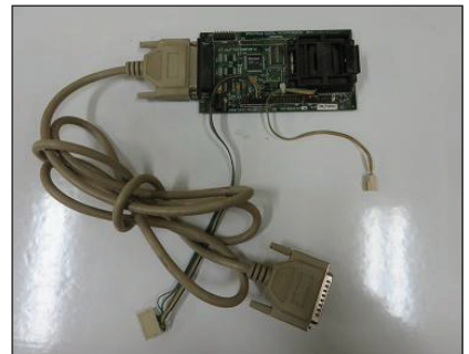
Port Spectrum Digital با سیم رابط کامپیوتر ◀
