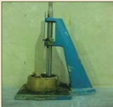
◀ دستگاه اندازه‌گیری زمان گیرش سیمان (سوزن ویکات)
