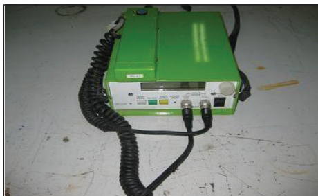
◀ دستگاه اندازه گیری درجه حرارت و درز ریل
