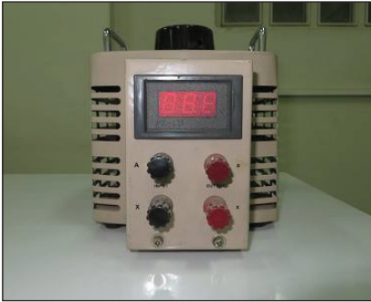
اتوترانسفورمر تک فاز با توان 2 KW ◀
