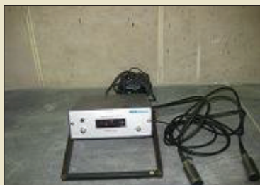
◀ دستگاه آزمایش اولتراسونیک جهت آزمایش بتن
