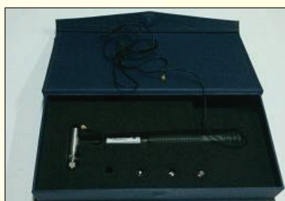
◀ چکش ضربه کوچک با ۴ سر (۲ عدد سر لاستیکی و ۲ عدد سر فلزی)
