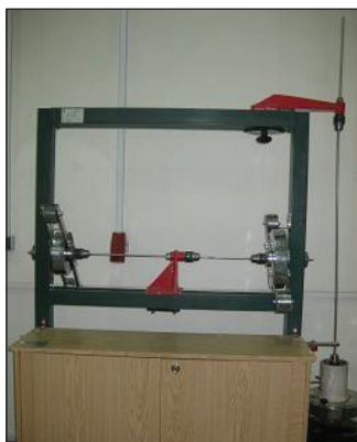
◀ نوسانات پیچشی سیستمهای یک و دو درجه آزادی بدون مستهلك کننده
