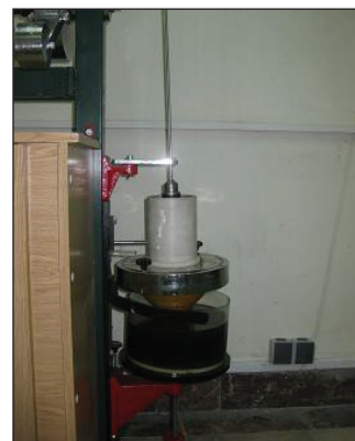
◀ تست نوسانات پیچشی با مستهلك کننده ویسکوز
