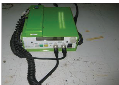
◀ دستگاه اندازه گیری درجه حرارت و درز ریل
