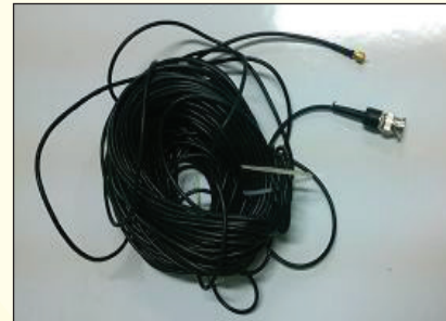
◀ سییم ۲۰ متری یک سر اتصال به Data Logger و یک سر اتصال به شتاب سنج
