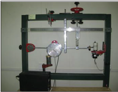
◀ تست ارتعاشات عرضی آزاد و اجباری با دمپینگ و بدون دمپینگ
