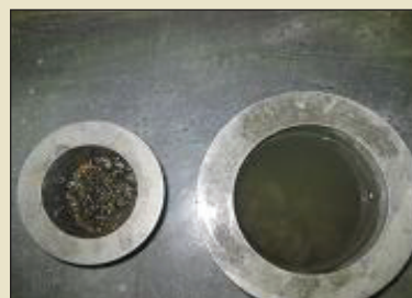
◀ قالب اندازه گیری چگالی و جذب آب شن و ماسه
