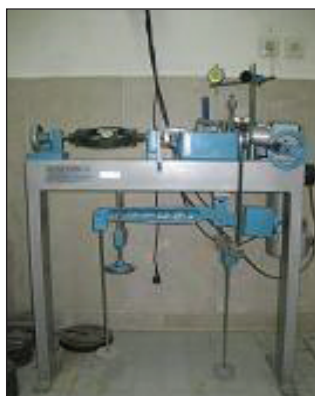
◀ دستگاه آزمایش برش مستقیم در ابعاد نمونه ۵ در ۵ سانتی متر
