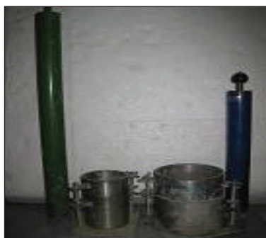
◀ تجهیزات آزمایش تراکم سبک و سنگین
