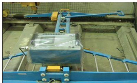
◀ دستگاه اندازه گیر پارامترهای هندسی خط
