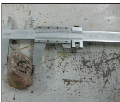
◀ کولیس تعیین ابعاد سنگ دانه‌های کروی و گردگوشه
