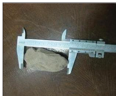
◀ کولیس تعیین ابعاد سنگ دانه‌های طویل
