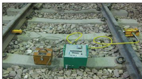
◀ دستگاه اندازه گیری مقاومت (SSTP) جانبی خط
